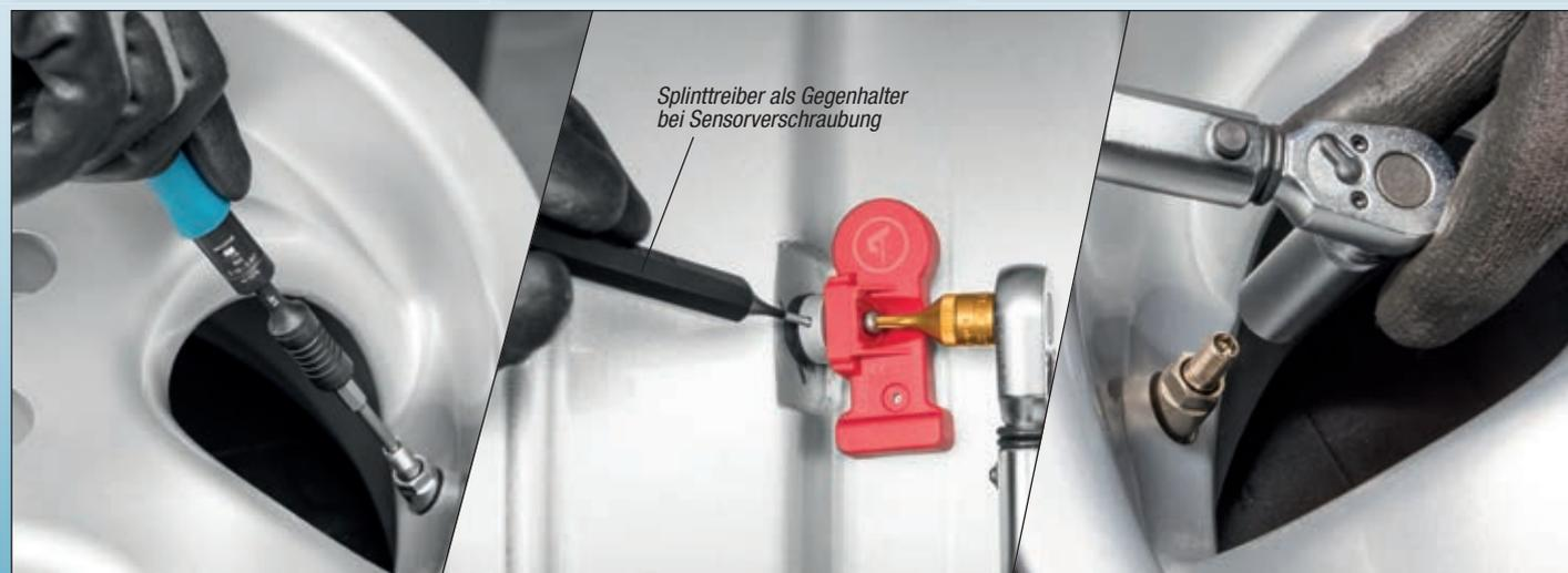
Splintreiber als Gegenhalter bei Sensorverschraubung
