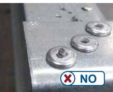
Bei zu groß gebohrten Bohrlöchern und zu hohen Stiftbruchlasten bei weichen Materialien kann der Standard-Blindniet durchziehen, so dass der Nietstift außerhalb der Blindnietöhse abreißt und hervorsteht. Der Nietdorn des ALFO® FLEX verriegelt sicher innerhalb der Blindnietöhse.
