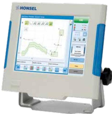
Für erweiterte Anwendungsfälle können mit einem Displaymodul bis zu acht Messwertfassungsmodule verbunden werden.
