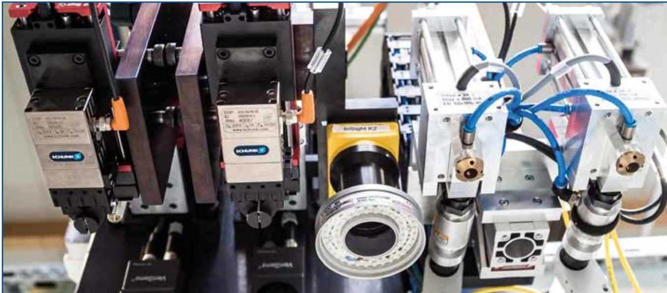
Zuführtechnik beschreibt den Vorgang, Schüttgüter lagerichtig einem Verarbeitungsprozess zuzuführen. Diese Technologie ist schon seit Jahren Standard in der HONSEL Automation. Je nach Anwendungsfall und Kundenanforderung kann ein Verbinder über einen Schlauch zugeschossen oder über ein Pick- & Place-System druckluftfrei direkt in die Übergabeeinheit des Verarbeitungsgerätes zugeführt werden.
