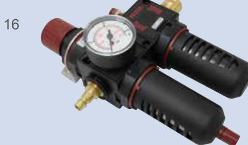
Für VNG-Geräte Wasserabscheider / Druckminderer / Nebelöler Wartungseinheit 2-teilig G3/8 mit Kunststoffschutzkorb, Befestigungswinkel, Stecknippel G3/8, Schnellschlusskupplung und 1L Luftmotorenöl.
