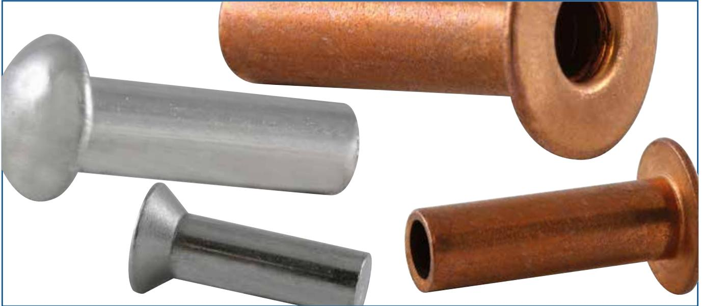
Als „Industrieniete“ oder „DIN-Niete“ bezeichnet man die klassischen **einteiligen Verbindungselemente**, deren Verarbeitung **beidseitig** des Bauteils erfolgt. Die Verbindung wird durch Umformung des Nietschaftes mit axialem Druck auf das Schaftende ausgebildet, wobei dies mit Hilfe eines einfachen Döppers mit Gegenhalter, verschiedenen Handwerkzeugen oder speziell entwickelten Sondermaschinen geschehen kann.
