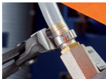
10 98 I220: Abdichten Schlauchanschluss an Zentralschmierung
