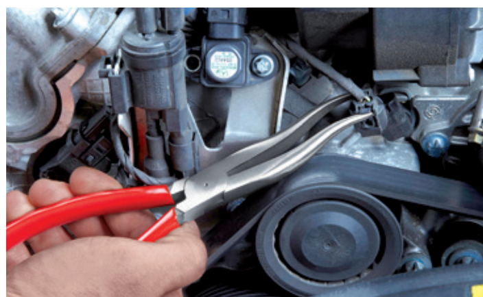
Schonendes Lösen von Schläuchen in schwer zugänglichen Bereichen.
