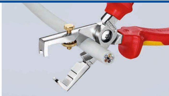
Induktiv gehärtete Scherschneide mit Präzisionsschliff zum quetschfreien Schneiden von Kupferkabeln bis Ø 15 mm (5 x 2,5 mm²)
