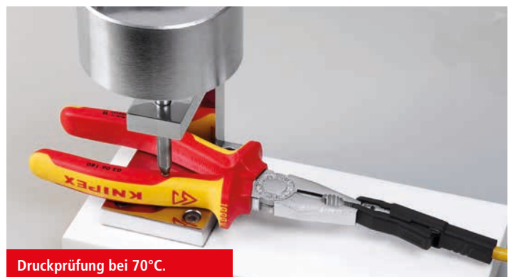
Prüfung der Haftfähigkeit der VDE-Hüllen mit 500 N bei 70°C.
