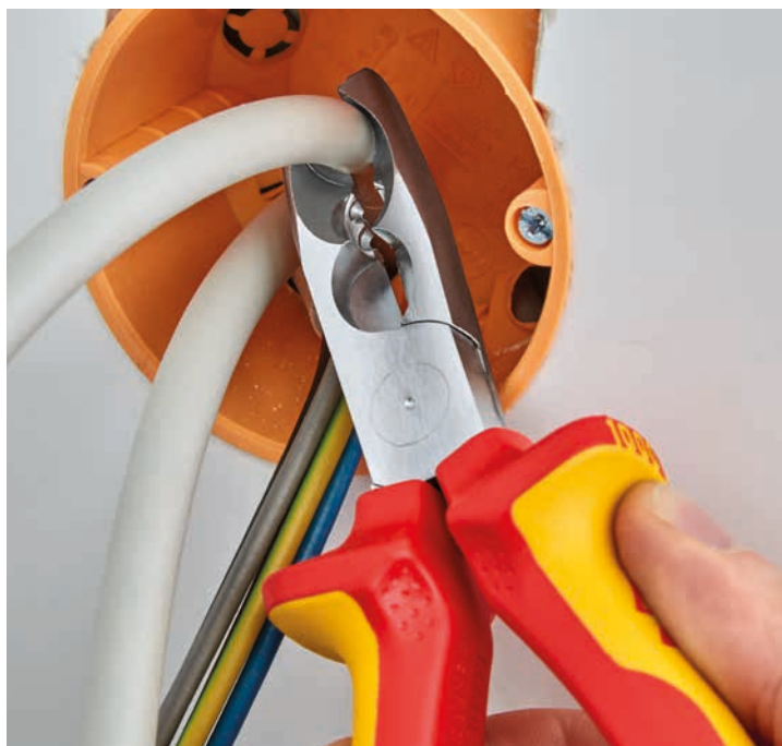
Rundschnitte mit Tiefenbegrenzung: zum leichten und beschädigungs- freien Abmanteln
