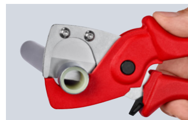
Das hochfeste, scharfe Messer schneidet Verbund- und Kunststoffrohre glatt und gratfrei
