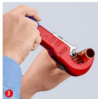
3 Durch Drehung schneiden und dabei mit dem ergonomischen blauen Drehknauf nachstellen ...
