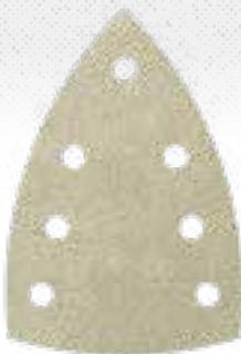
**Vorteile:** Erhöhte Schleif- und Abtragsleistung durch spezielles, hitzevergütetes Aluminiumoxid-Schleifkorn - Reduziertes Zusetzen durch schleifaktive Wirkstoffe im Nachlack und halboffene Kornstreuung - Hohe Flexibilität bei gleichzeitig guter Stabilität und Reißfestigkeit durch lateximprägnierte Papier-Unterlage
