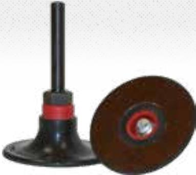
**Vorteile:** Sicheres Aufspannen der QMC-Scheiben - Optimiertes Schleifverhalten (Aggressivität, Oberflächengüte) durch drei Härtegrade - Einfache Unterscheidung der Härten durch Farbringe - Spannstift abschraubbar, dadurch über 1/4"-20 Gewinde Einsatz auf Winkelstabschleifer oder mit Adapter QCA 555 möglich
