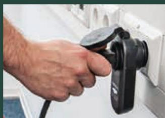
1. Netzsauger mit der Empfängersteckdose einstecken.
