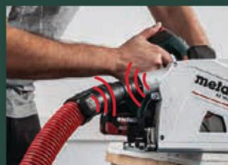
3. Netzsauger auf »manuell« drehen oder einschalten. Akku-Maschine starten. Sauger wird automatisch durch die Wahrnehmung von Vibrationen ein-/ausgeschaltet.
