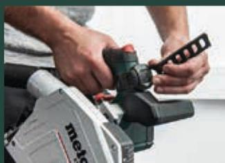
2. Sender mit Multiband am Schlauch hinter der Muffe oder direkt an der Maschine befestigen.
