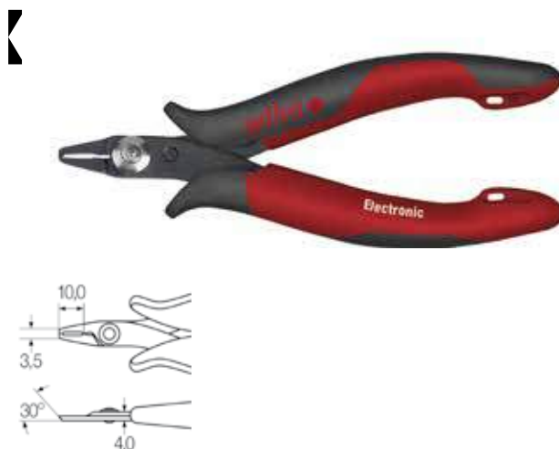
sehr schmaler, kurzer Kopf ohne Wate Z 46 0 03
