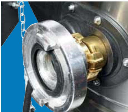
C-Kupplung am Behälter oder am Schlauch mittels Adapter
