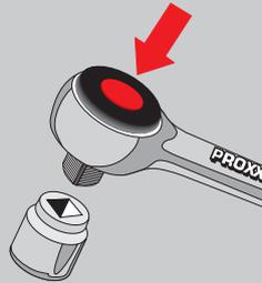
Aus einem Stück aus CrV-Stahl geschmiedet. Gehärtet und mit makelloser Verzahnung: mehrere der 52 Zähne rasten gleichzeitig ein und übertragen extrem hohes Drehmoment. Mit Entriegelungsmechanismus: Lösen der Einsatzwerkzeuge durch Knopfdruck. Optimaler Oberflächenschutz: 2 x vernickelt und danach matt-verchromt. Unlösbarer Griff aus öl- und säurefestem TPR (Thermoplastic Rubber) mit praktischer Bohrung zum Aufhängen.
