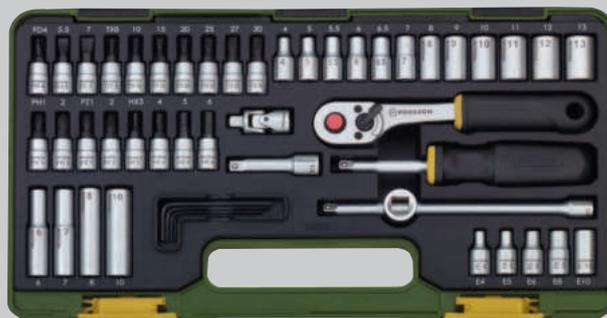
Steckschlüsseleinsätze von 4 – 13 mm. Tiefbetteinsätze 6 – 10 mm (für weit überstehende Gewindebolzen). Schraubereinsätze mit Vierkantantrieb für Schlitzschrauben, Kreuzschlitzschrauben, TX-Schrauben (mit stirnseitiger Bohrung) und Innensechskantschrauben. Außen-TX-Einsätze Gr. E 4 – E 10. Kreuzgelenk. 2 Verlängerungen. Schrauberriff mit Vierkant. Dazu 5 abgewinkelte Innensechskantschlüssel Gr. 1,25 – 1,5 – 2 – 2,5 und 3 mm.
