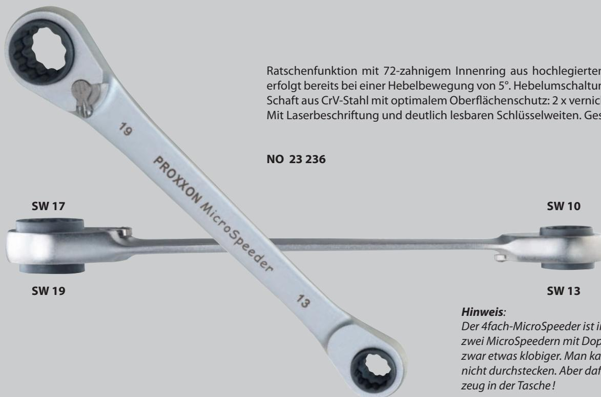
Ratschenfunktion mit 72-zahnigem Innenring aus hochlegiertem Spezialstahl. Der Antrieb erfolgt bereits bei einer Hebelbewegung von 5°. Hebelumschaltung für Rechts- und Linkslauf. Schaft aus CrV-Stahl mit optimalem Oberflächenschutz: 2 x vernickelt und 1 x mattverchromt. Mit Laserbeschriftung und deutlich lesbaren Schlüsselweiten. Gesamtlänge 210 mm.
