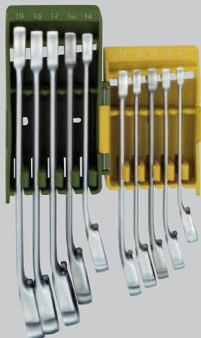
Mit Ratschenmechanismus ringseitig und Hebelumschaltung. Für Rechts- und Linkslauf. Für zeitsparendes Arbeiten ohne Umsetzen. Ideal zum Schrauben an Planflächen durch 15°-Abwinkelung ringseitig. Eingeklinkt im funktionalen Klapphalter hat jeder Schlüssel seinen festen Platz. Der ideale Begleiter zur Baustelle. Mit zusätzlicher Option der Wandbefestigung in der Werkstatt. Mit deutlichen Größenkennzeichnungen. Ordnung für immer!
