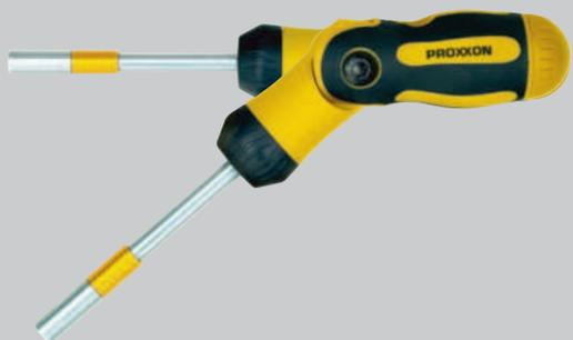
Verrastung des Griffes durch Knopfdruck in normaler und abgewinkelter Version. Umschaltung von Rechts- auf Linkslauf durch Drehen des Schaltringes. In Mittelstellung wird die Ratschenfunktion eliminiert. Autolock-System: Bits werden nach Einschieben automatisch mittels Feder und Magnet fixiert. Zum Entnehmen Auswerfer nach hinten schieben.
