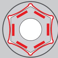
Der Antrieb erfolgt nicht über die Ecken, sondern an den Flanken. Für hohe Kraftübertragung, Kanten der Muttern bleiben unberührt.
